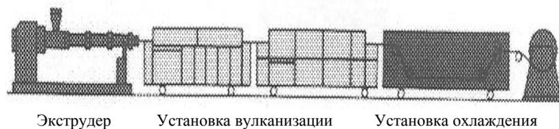
**Рис. 1.10. Экструзионная и вулканизационная установка для профилей**
