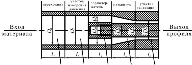
**Рис. 5.1. Компоновка формующих каналов экструзионной головки:**
